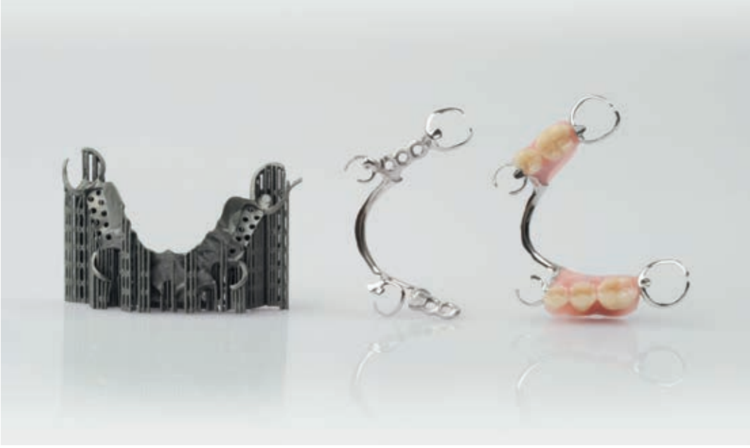
Şekil 7: Lazer sinterlenmiş çıkarılabilir hassas tutuculu protez üretim aşamaları: üretildikten hemen sonra diş protezi, tamamlandıktan sonra destek yapıları çıkarılmış ve yüzey cilalanmış (soldan sağa)
