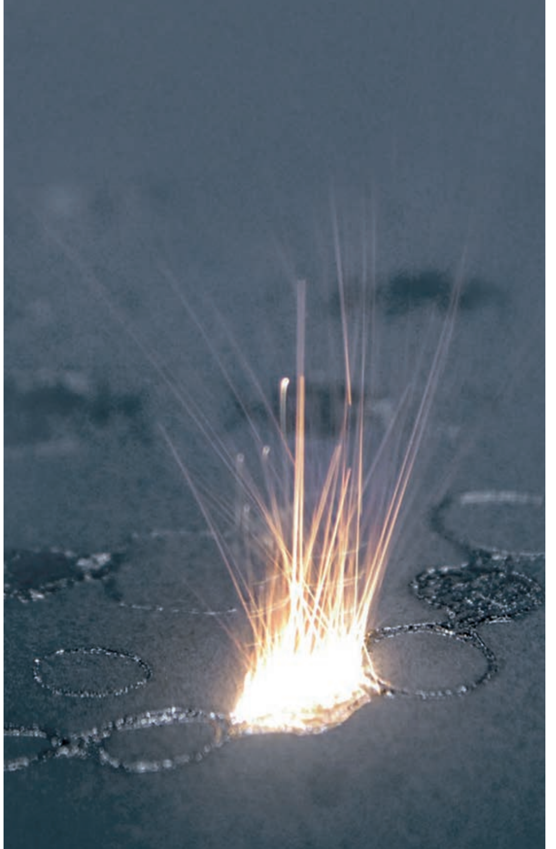
Şekil 8: Dijital üretim: 200 W ve 1400 °C ile lazer, katman katman demir tozunu eriterek şekil veriyor
